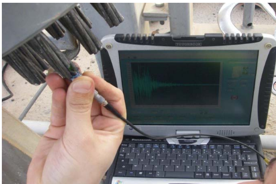
Figura 6: Inspección por Ultrasonidos
